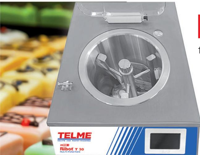
L'agitateur, pourvu d'éléments racleurs mobiles, pousse vers le haut le produit qui retombe ensuite par effet de gravité. Le cycle à température donne, avec des quantités différentes de mix, toujours le même résultat: une glace fine et crémeuse.
