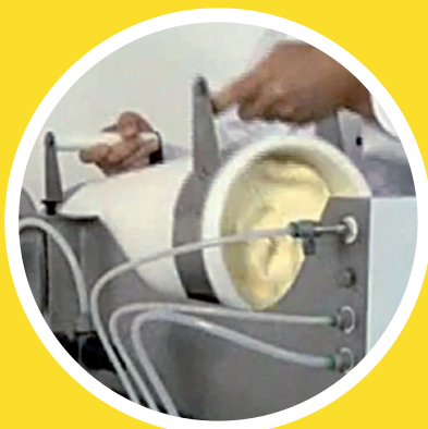
3. Remontage du cylindre
